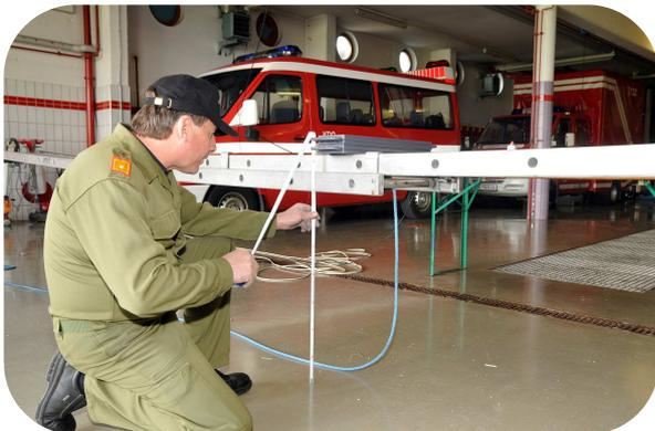
Bei der **Belastungsprüfung** wird die Schiebeleiter waagrecht auf die maximale Benutzungslänge ausgezogen und auf zwei Böcke aufgelegt. In der Leitemitte wird der Abstand zum ebenen Boden gemessen. Danach wird die Leiter mit der Prüflast von 30 kg belastet. Nach einer Minute wird der Abstand zum Boden nochmals gemessen. Der Messunterschied darf dabei bei den jeweiligen Leiterlängen vorgegebene Werte nicht überschreiten.
